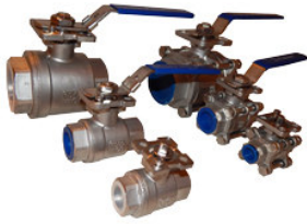
Шаровые краны с площадкой под привод ISO 5211
