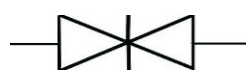
Вариант 3. Знак "Задвижка клиновидная или шиберная". Шаровой кран так обозначать неверно, но обозначают так часто.
