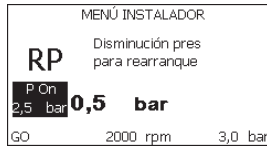
Figura 17: Configuración de la presión de reencendido
