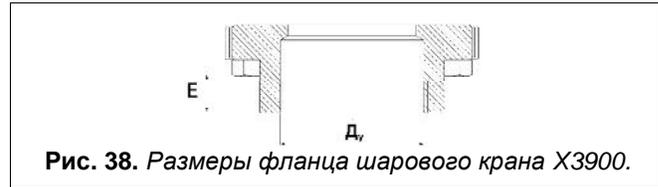
Рис. 38. Размеры фланца шарового крана Х3900.
