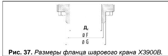
Рис. 37. Размеры фланца шарового крана Х3900В.
