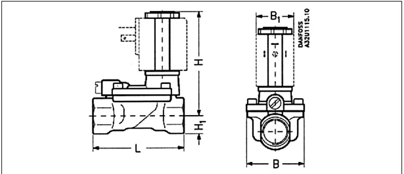
Рис. 3. Габаритные и присоединительные размеры соленоидного клапана.
