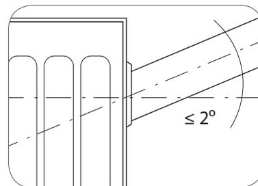
Во избежание аварии допустимо отклонение оси коллектора радиатора от подводящих труб не более  $2^\circ$  (рис. 2).
