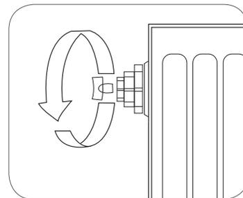
Для возможности демонтажа радиатора на подающий и обратный трубопровод устанавливайте запорную или запорно-регулирующую арматуру.
