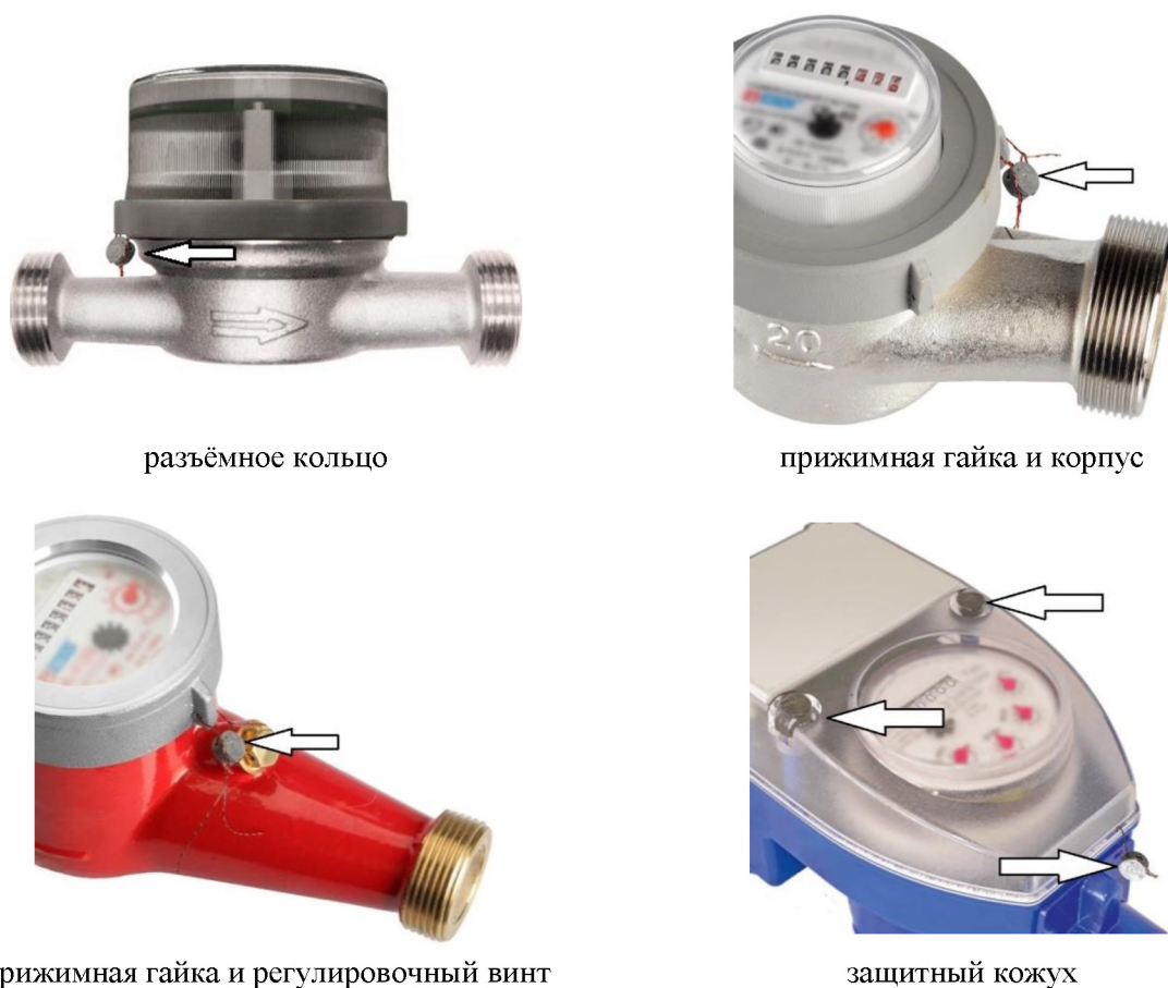
Рисунок 8 – Схема пломбировки от несанкционированного доступа, обозначение места нанесения знака поверки счетчиков показано стрелкой
