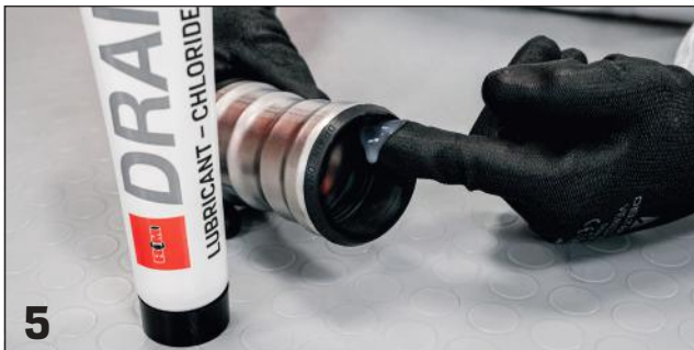
5 Lubrificazione zona interna guarnizione / Internal gasket lubrication
