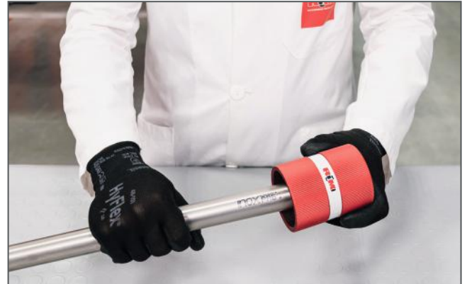
Sbavatura del tubo / Deburring the pipe
