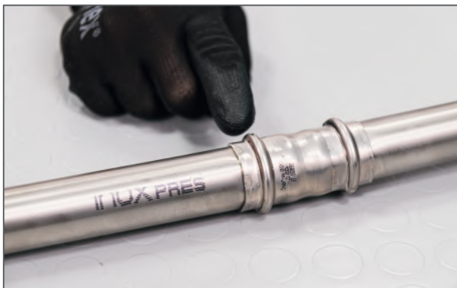
Controllo della pressatura / Checking the press connection
