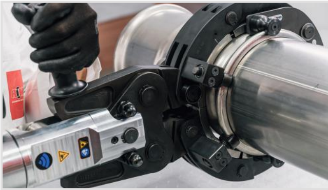
Assemblaggio pressatura n°2 / Press assembly phase 2
