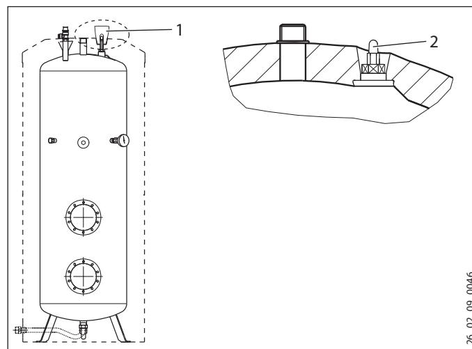
1 Защитное устройство, используемое при транспортировке
