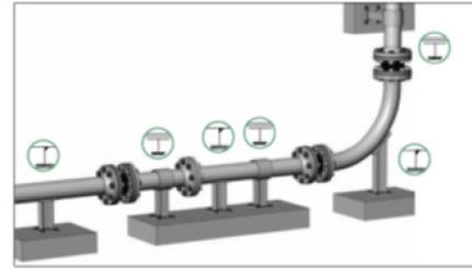
При монтаже компенсаторы не должны испытывать дополнительных нагрузок от трубопровода (изгиб, сжатие, растяжение, кручение, перекосы, неравномерность затяжки крепежа).
